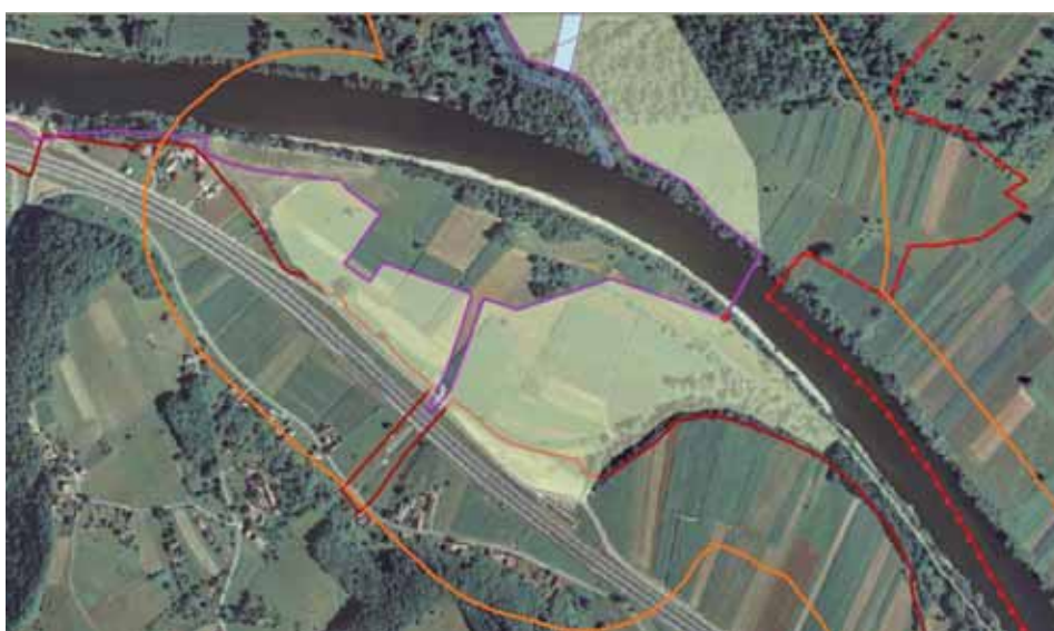
Slika 25: Prikaz območja gradbišča jezovne zgradbe (rumena površina) ter 200 m pasu okoli zunanje meje gradbišča (oranžna linija)
